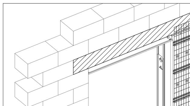
E' necessario inserire un architrave. Lasciare una luce di circa 1 o 2 cm. tra l'architrave e la traversa superiore del controtelaio.
